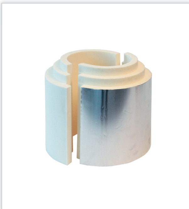
Izolacja formowana, materiał PIR/PUR z paroszczelnym pokryciem. Gęstość [kg/m 3 ]: od 40 do 250.
