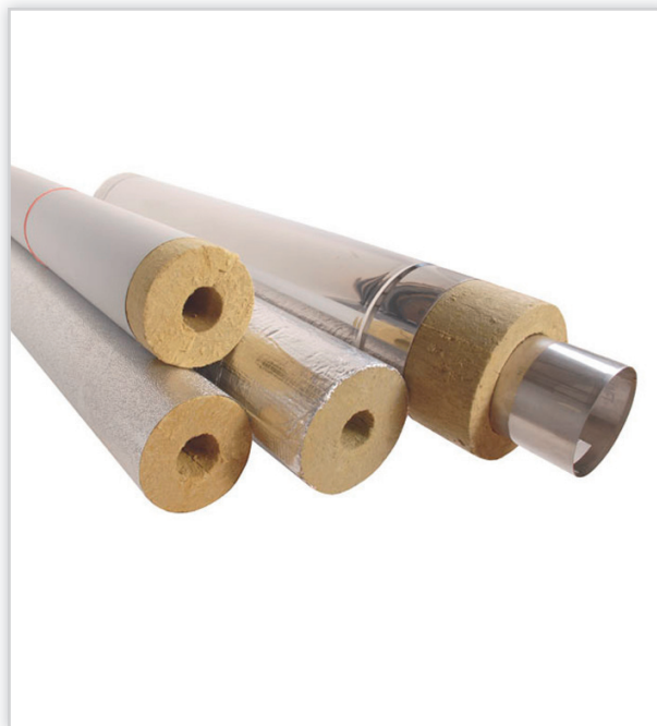
Otuliny z wełny mineralnej. Rodzaj materiału izolacyjnego: wełna mineralna. Klasa palności materiału izolacyjnego: niepalny wg PN-93/B-02862. Współczynnik przewodności cieplnej przy t_m=20^{\circ}\text{C} [W/(mK)]: 0,043. Gęstość [kg/m 3 ]: 80. Temperatura dopuszczalna [°C]: 250. Długość handlowa [mm]: 1000.
