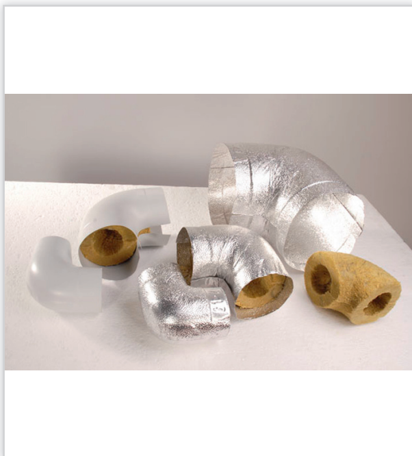
Kolana z wełny mineralnej. Rodzaj materiału izolacyjnego: wełna mineralna. Rodzaj płaszczka: folia aluminiowa wytłaczana z efektem rolowania. Sposób zamknięcia: nity Kocopak-Alu lub stalowe. Klasa palności płaszczka: niepalny. Współczynnik przewodności cieplnej przy t_m=20^{\circ}\text{C} [W/(mK)]: 0,043. Gęstość [kg/m 3 ]: 80. Temperatura dopuszczalna [°C]: 250.
